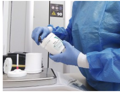
Herstellung Sie erfolgt im Sandwichverfahren mittels vollautomatischen Rührsystems bei niedriger Drehzahl.
