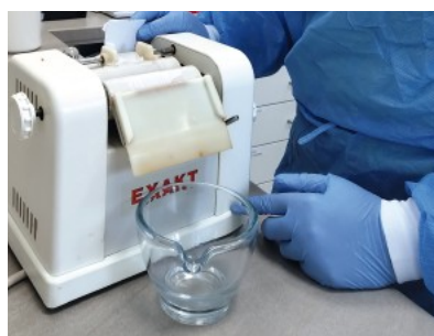
Dreiwalzenstuhl Bei Suspensionszubereitungen sorgt er für eine gleichmäßige Teilchenzerkleinerung.
